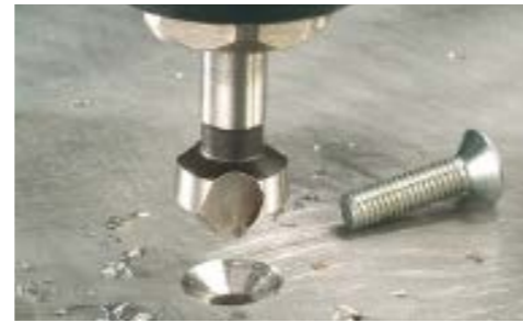
boven: Een soevereinboor om de kop te verzinken in het staal, zo krijg je een gladde naad.
