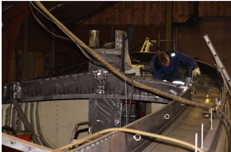
boven: Een soevereinboor om de kop te verzinken in het staal, zo krijg je een gladde naad.
